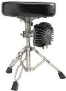
Figuur 17 Bass-Shaker gemonteerd op een kruk, zodat lage tonen (20-130Hz) voelbaar zijn als je er op zit.
