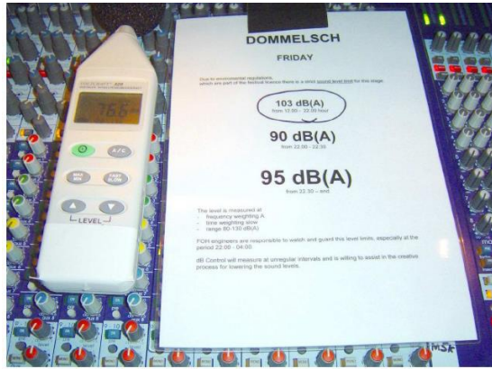
Figuur 13 Geluidsniveaumeter op de mengtafel met een instructieblad van de organisator met gegevens over instelling, tijden en maximale dB(A).
